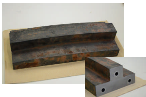
試作金型（温調配管内蔵）
