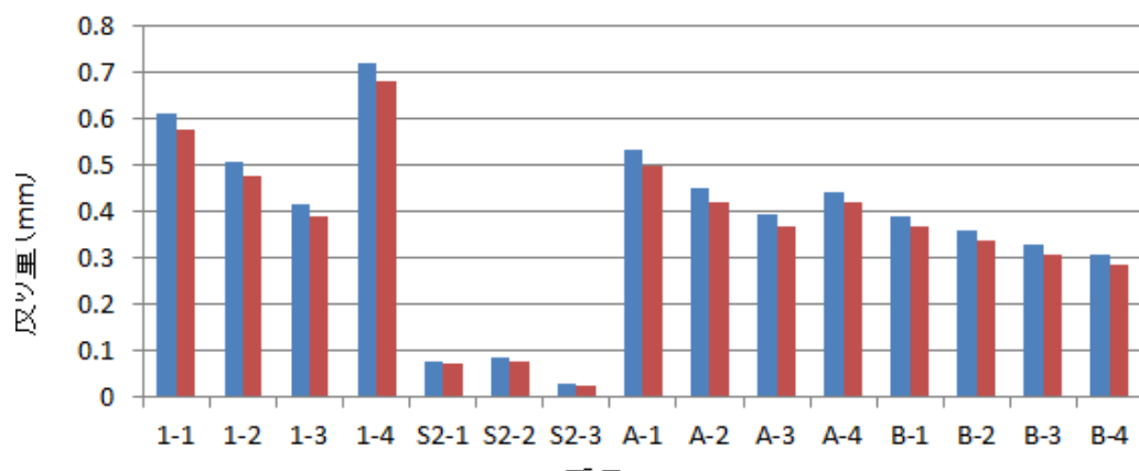
図 17 各放熱基板の反り量 (青: 室温時, 赤: 稼働時)
