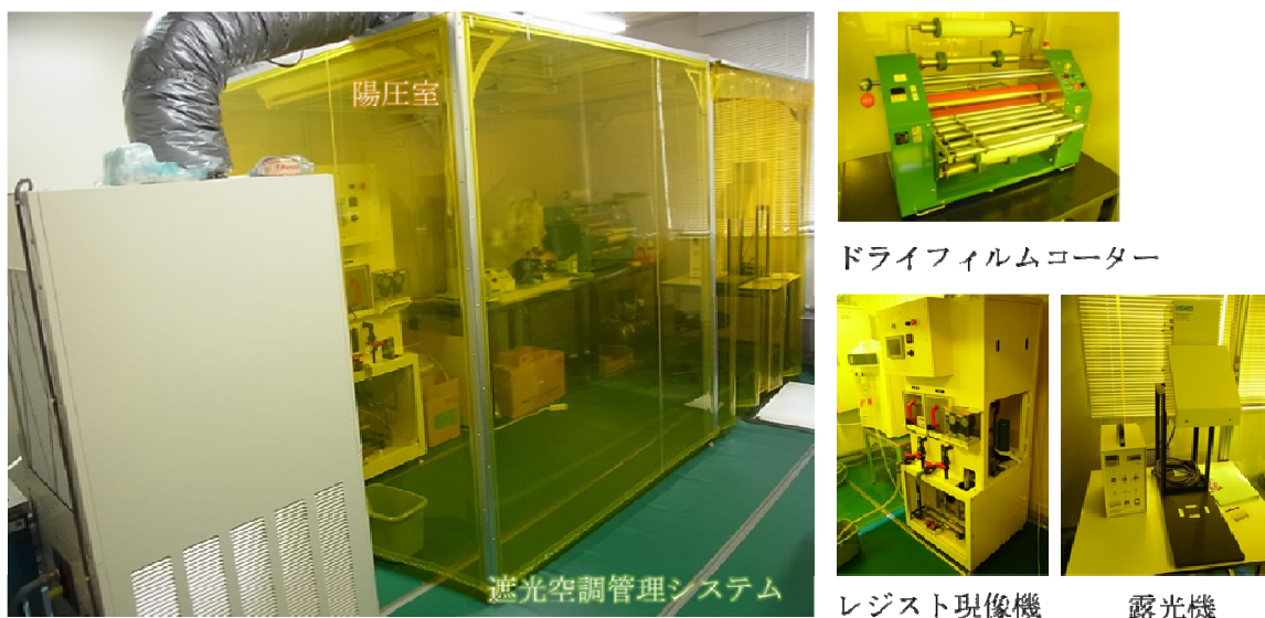
図 3-2-3. DFR ラミネート、露光、現像用の遮光空調管理システム
