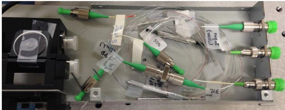
図 6 二次試作機に用いた2ビームでの干渉計
