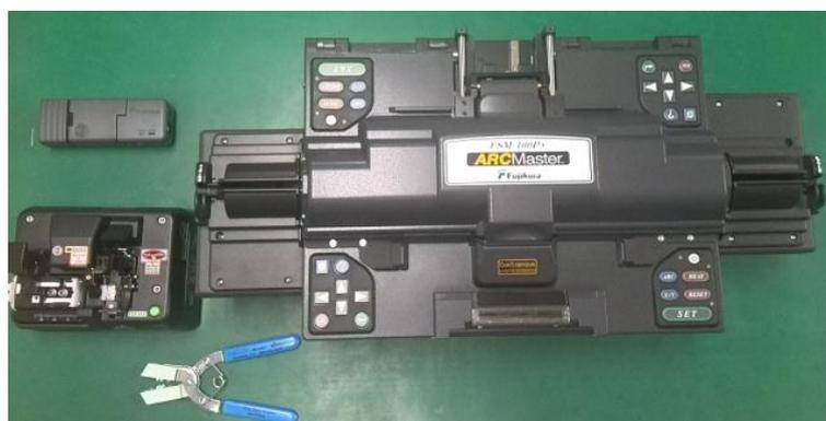
図 5 ファイバー融着接続機(Fujikura FSM-100P+)
