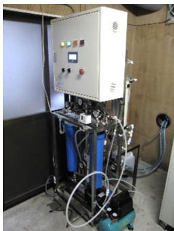
(濾過性能測定装置の概観)
