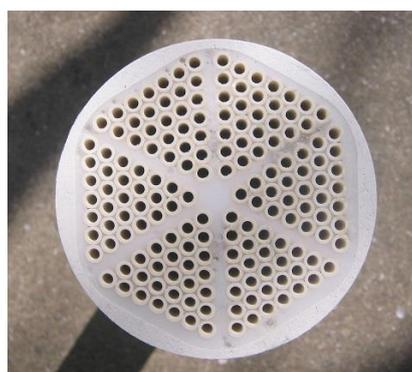
写真8 端面加工を行ったフィルターユニットの加工面
