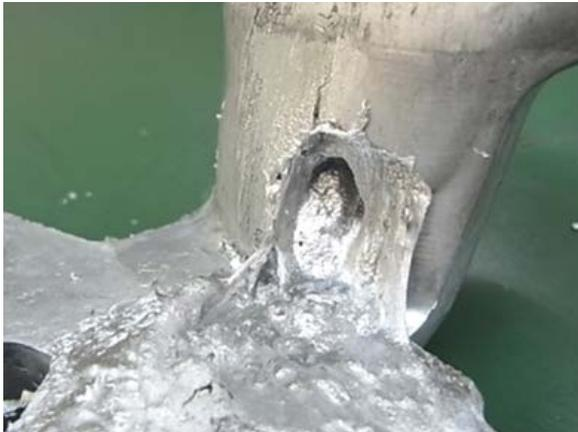
図2 チルタイム 2.0 s の時のランナーからの溶湯吹き出し
