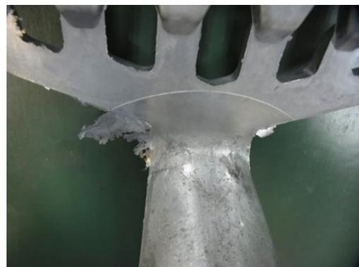
図4 鋳造実験結果「ビスケット」「ランナー」の破裂防止効果
