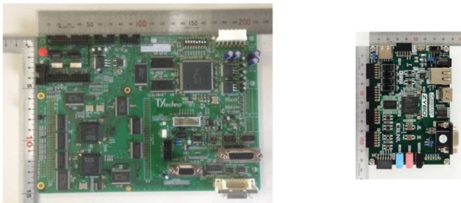
図 2-6 一次試作基板 (左) と SoC FPGA 基板 (右)
