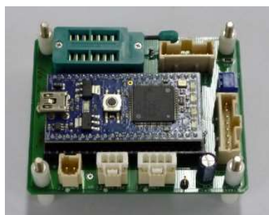
図 3-7 SLD パワー制御基板
