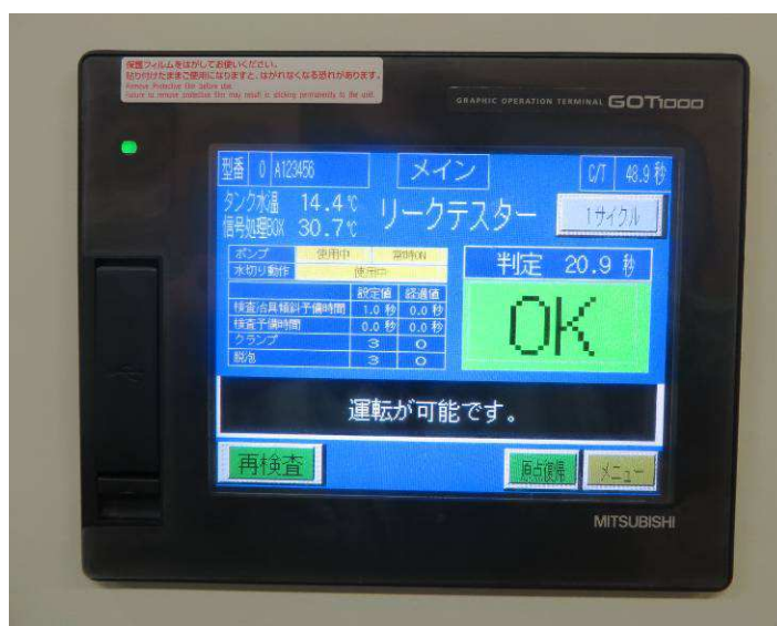
図 27 PLC モニター 気泡の漏れが無い OK 時(写真)
