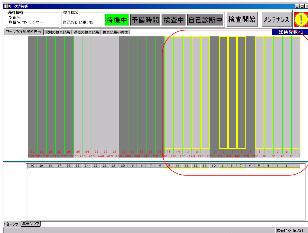
図 15 自己診断の判定結果の画面例
