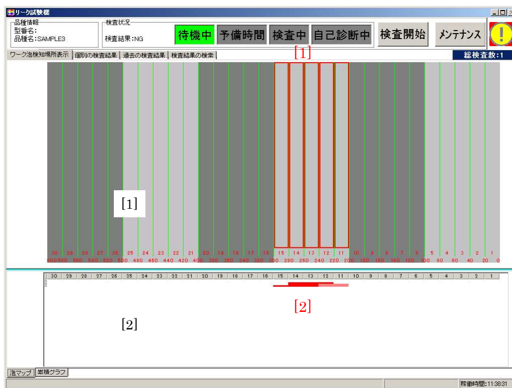
図 14 気泡を検出した判定結果の画面例
