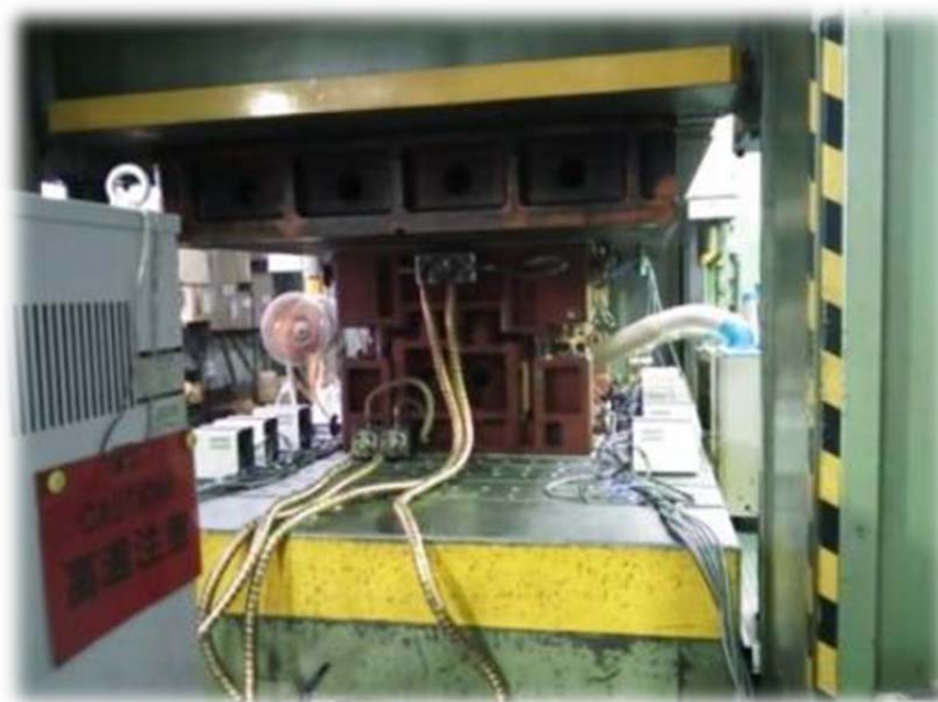
写真 6 金型昇温及び冷却実験状況
