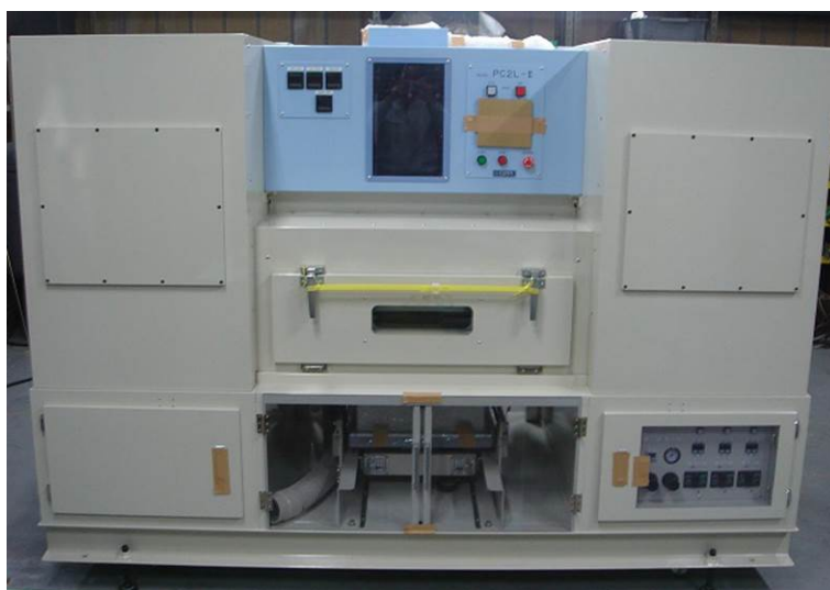
図8 粉体樹脂用のコーティングマシン写真
