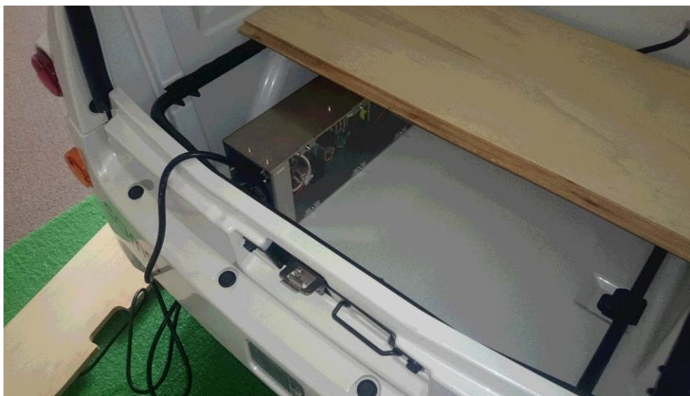
図36 充電器搭載状態
