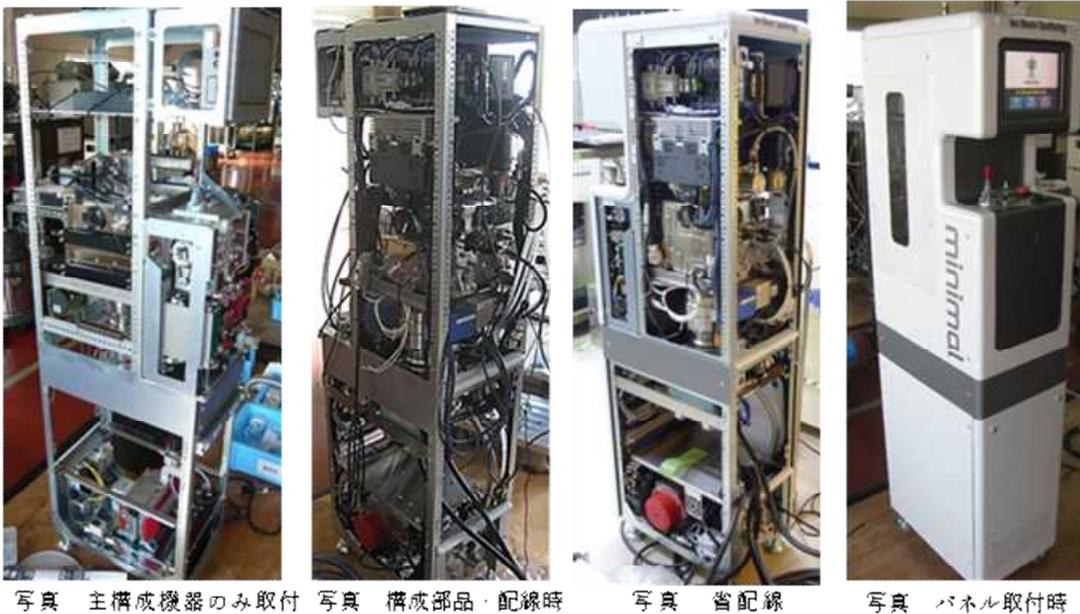
写真 主構成機器のみ取付 写真 構成部品・配線時 写真 省配線 写真 パネル取付時
