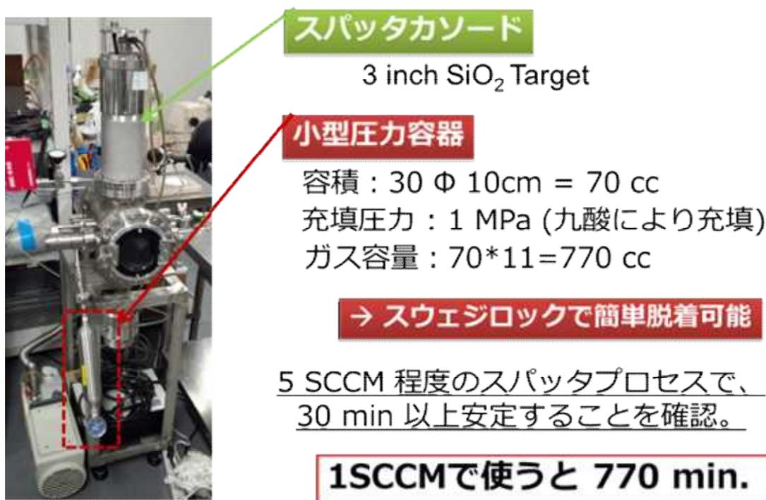
図5 スパッタカソードを使ったガス流量実験
