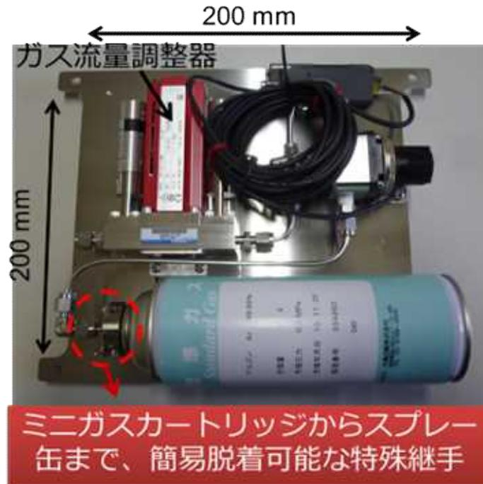
図7 プラズマガス導入機構
