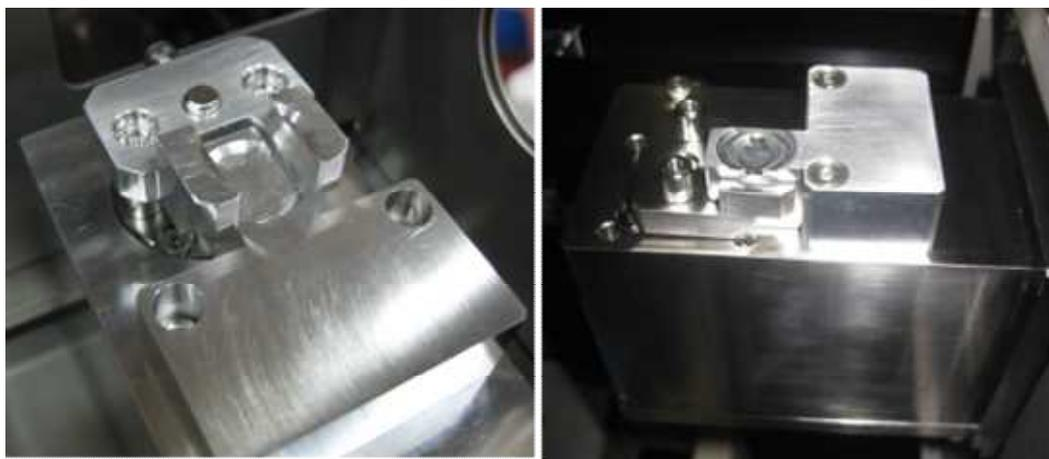
図30 ミニマルスパッタ装置用とミニマルイオンビームスパッタの基板ホルダ
