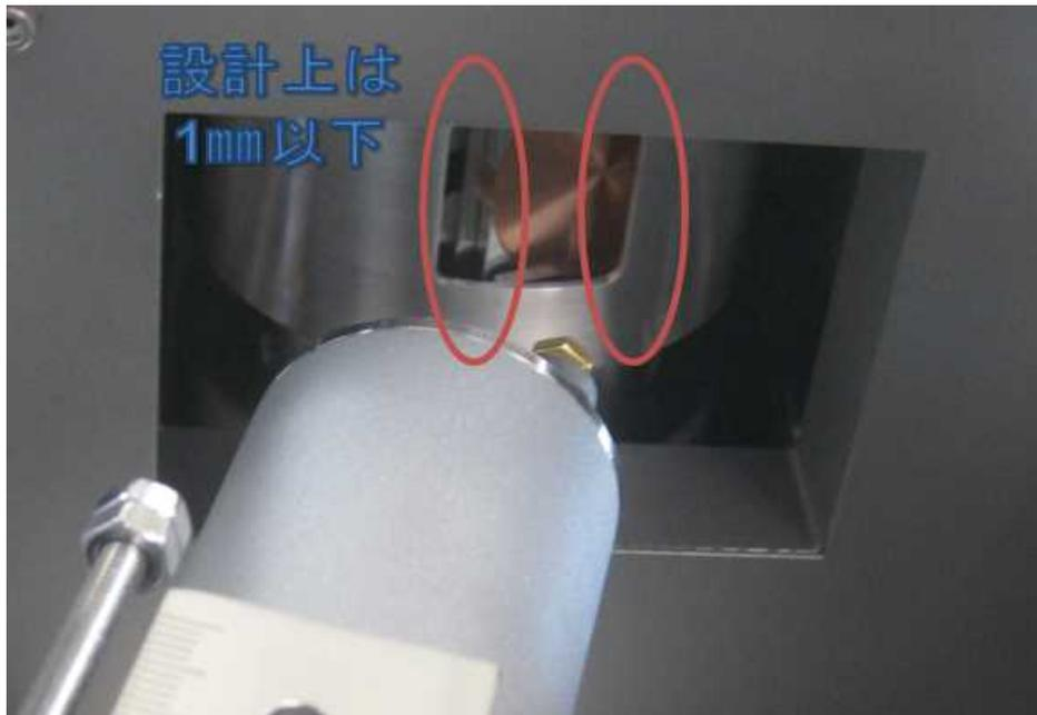
図4 5 回り込み防止版による、1 mm 以下の隙間
