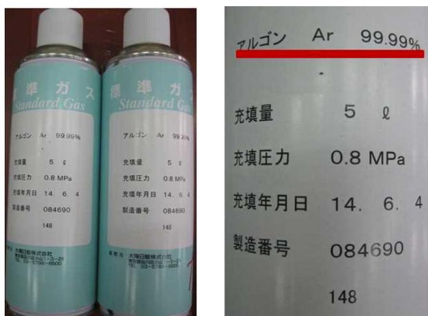
図10 超小型ガス貯蔵容器(スプレー缶)と純度
