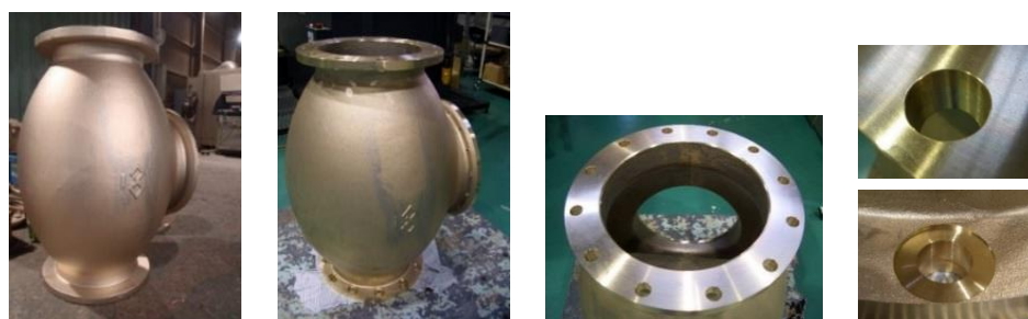
図 3-13 仕上げ後(左)と機械加工後(中央、右)
