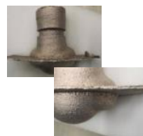
図 2-8 型ばらし後の試験片とショットブラスト後の湯口の部分
