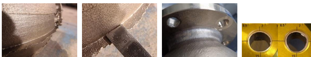
図 3-6 鑄バリ、ザグリ、鑄抜き穴
