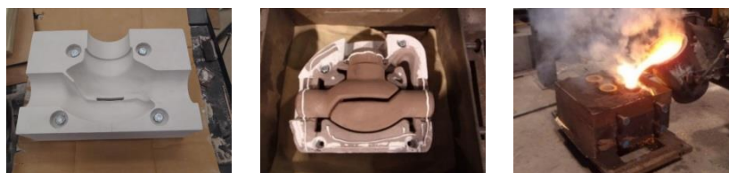
図 3-5 L=400\text{ mm} の砂型と鑄込み
