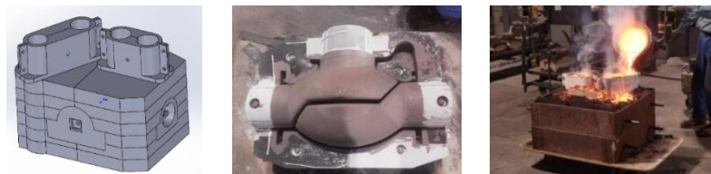
図 3-9 L=800mm の CAD 図と砂型と鋳込み
