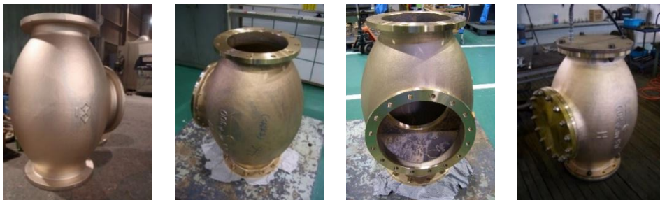
図 5-5 仕上げ後(左)、機械加工後(中央)と水圧試験の様子(右)
