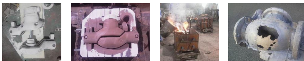
図 3-4 砂型と鑄込み、鑄物
