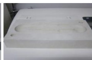
図 2-7 アルミナ材料で造型した鑄型
