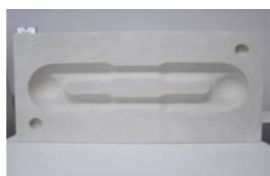
図 2-7 アルミナ材料で造型した鑄型
