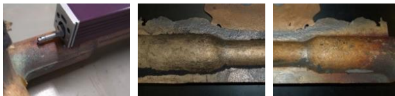
図 2-21 表面粗さ測定の様子と砂型の違いによる表面粗さ
