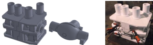
図 3-7 L=800mm の主型と中子の 3DCAD 図と石膏砂型(下型、中子)
