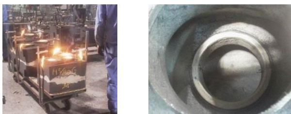
図 4-3 鋳込みの様子(左)と鋳込み後の弁座部分(右)
