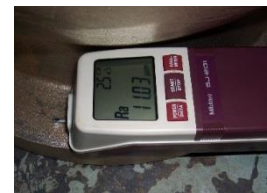
図 5-4 表面粗さの測定
