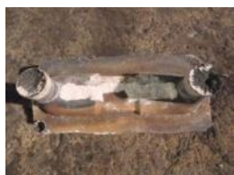
図 2-8 型ばらし後の試験片とショットブラスト後の湯口の部分
