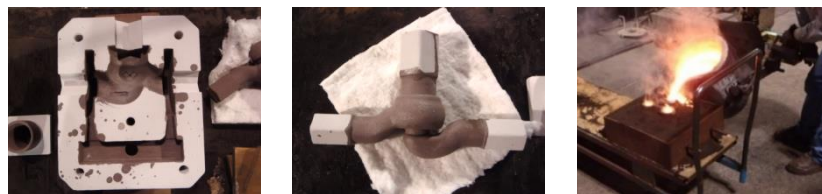
図 3-10 砂型と鋳込みの様子
