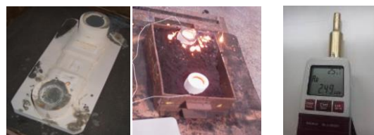
図 2-12 鑄込み後の砂型(左:1 回目、中央:2 回目)、表面粗さ(右)
