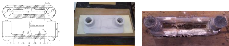
図 2-9 A 号供試材と A 号供試材の砂型、試験片
