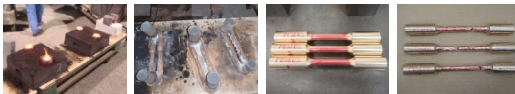
図 2-20 鋳込みと型バラシ後(左)、機械加工後(中央)、試験後(右)
