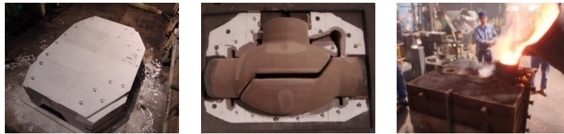
図 5-3 L=1300mm の造形作業と鋳込みの様子
