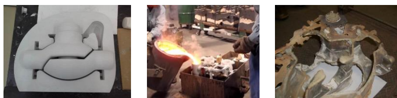
図 3-3 試作 1 回目の砂型
