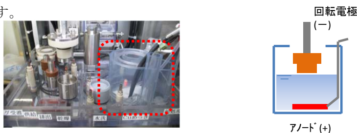
図 2-2. 平成 27 年度に装置に搭載した小型めっきセル
