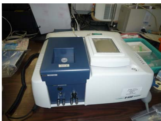
図 3-12. 改良した分光光度計（シリンジポート付き試料カバーとスターラー付き恒温セルホルダー）
