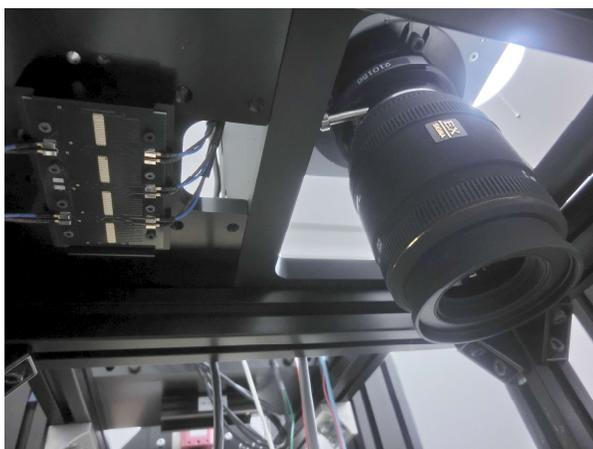
図12 50,000fps 高速度4Dカメラセンサーの光源部と高速度カメラレンズ部
