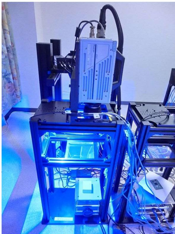
図11 製作した50,000fps 高速度4Dカメラセンサー
