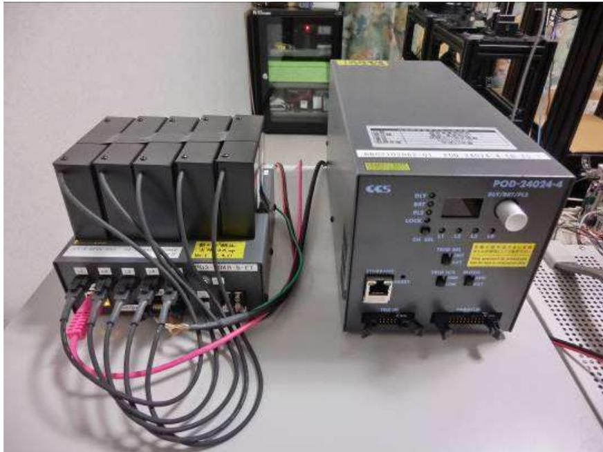
図5 同期装置（左側が完成品、右側は一次試作品）
