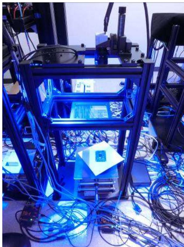
図9 製作した2,000fps 高速度4Dカメラセンサー (本体架台)
