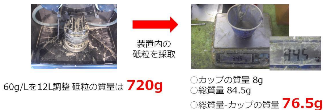
図 5-2. 装置内にたまった砥粒の重量
