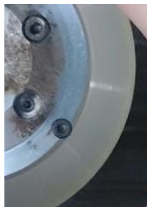
図３－２０．２００時間走行後のプーリー取り付け状態 図３－２１．隙間部拡大
