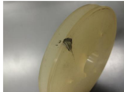
図 4-4. プーリーの傷
