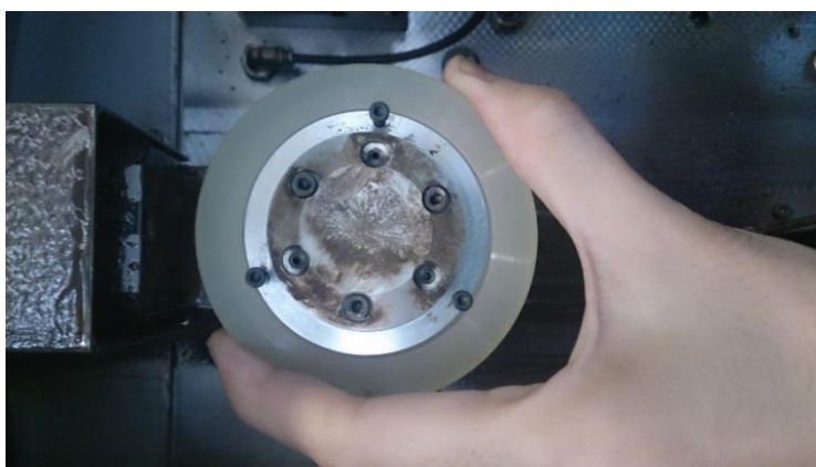
図３－２０．２００時間走行後のプーリー取り付け状態 図３－２１．隙間部拡大
