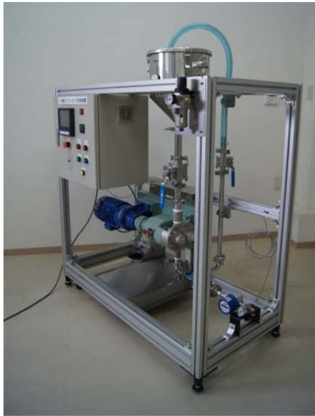
図3 微粒子スラリー供給装置と性能試験結果
