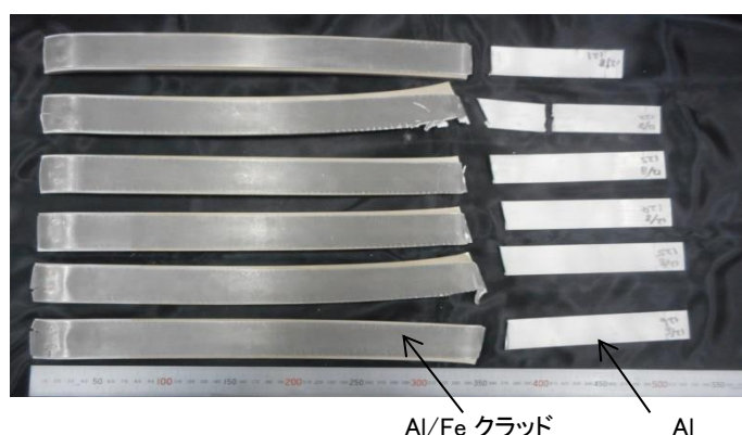
図19 B案で作製したAl/Fe クラッド材
