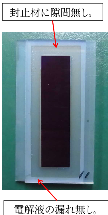
図19 作用極基板と対極基板とが貼り合わされた様子 (FTOガラスサイズ: 24mm×50mm、色素: DN291)
