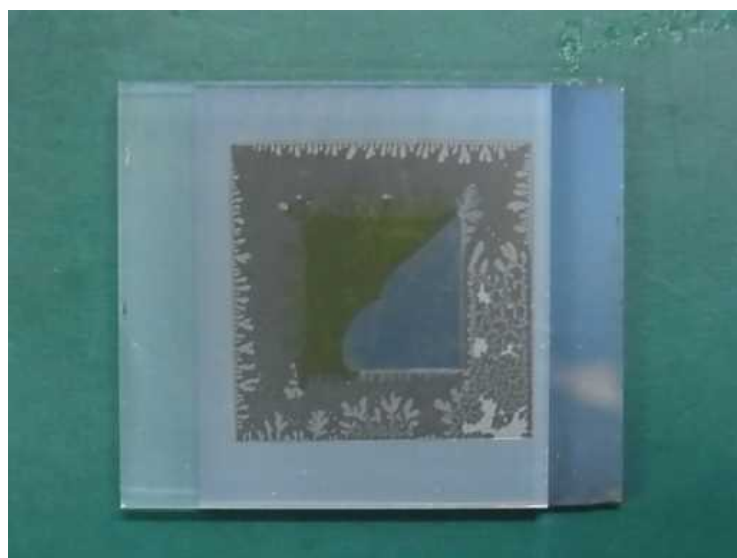
図14 貼り合せ時の加圧が弱すぎた状態
