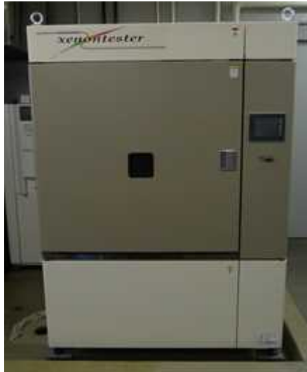
図 29 耐候性評価システム（キセノン） 出典：京都府中小企業技術センターの HP ( http://www.mtc.pref.kyoto.lg.jp/tec/int/hk/taikousei )
