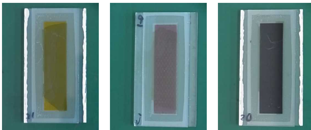
図24 作用極基板と対極基板とが貼り合わされた様子（左：D131S、中央：DN285MorS、右：DN496）
