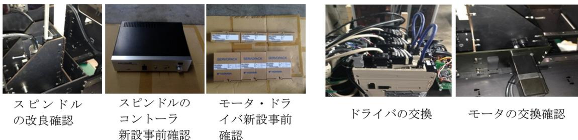
図2-1-2-3 スピンドルの交換（2）
