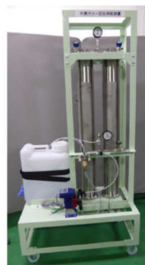
Fig. 2-4-1 水素ガス一定圧供給装置 (昨年度購入)
