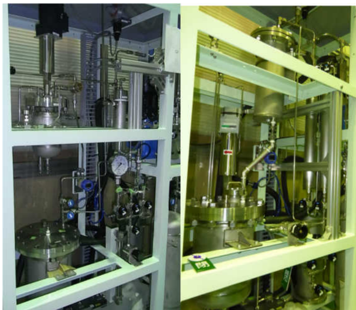
Fig. 2-2-3 反応器廻り改造前後
