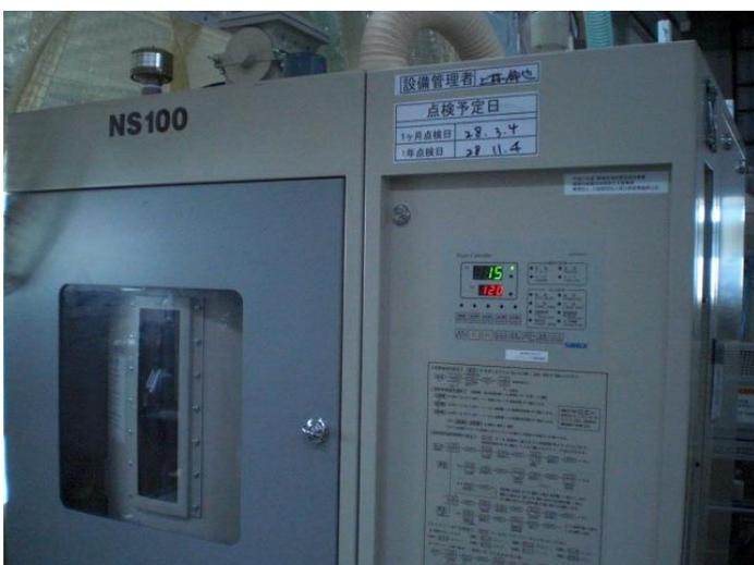
図19 導入した材料乾燥機
