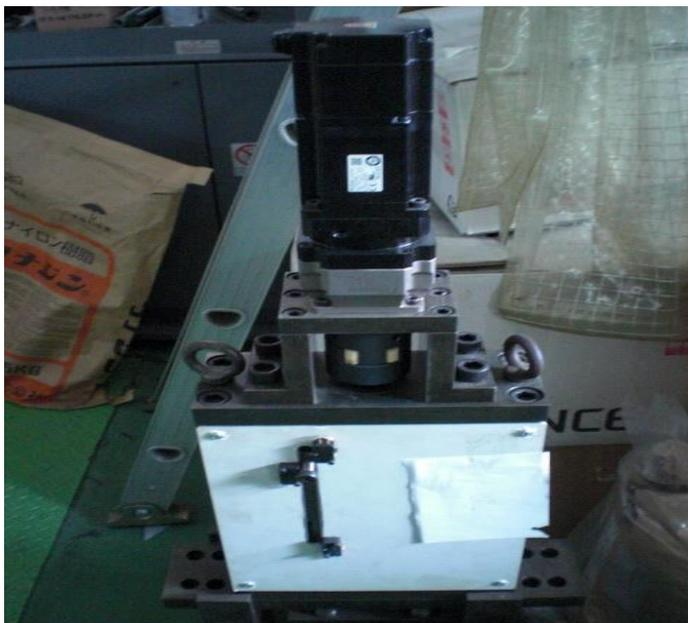
図 2 3 開発した圧縮機構
