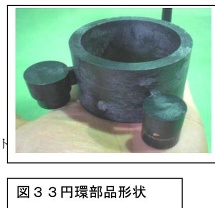
図 3 2 に円環部品形状と測定部位を示す図 2 8 と同様に圧縮/排出操作を行うものである。真円度測定は高さ方向中心位置とその上下 10mm オフセットした合計 3 ヶ所の測定を行った。図 3 3 にその試作した製品の写真を示す。
