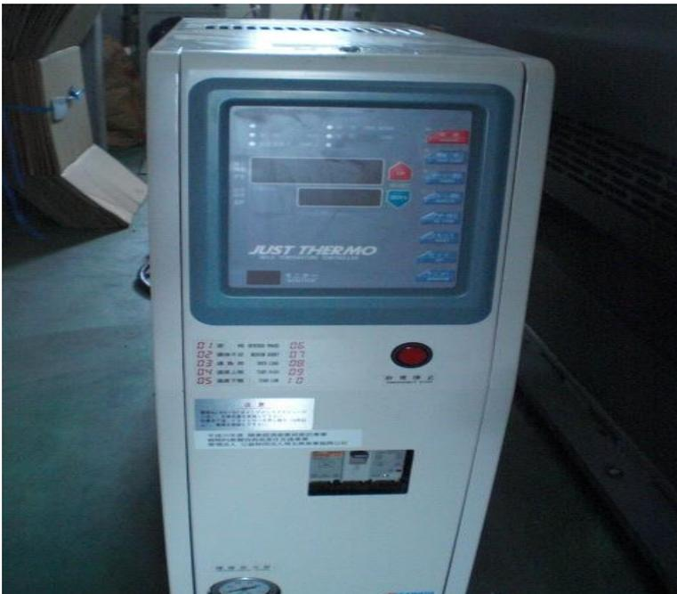
図 2 1 導入した金型温度調整機
