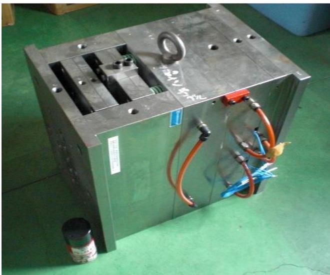
図25 製作した中央支柱部品用金型
