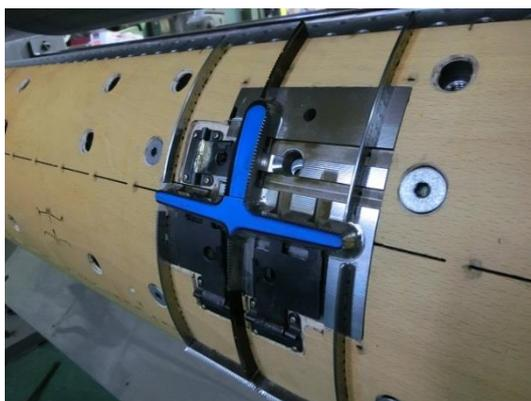
図7 ハイブリッド抜型（金型刃と切刃とを接続した様子）
