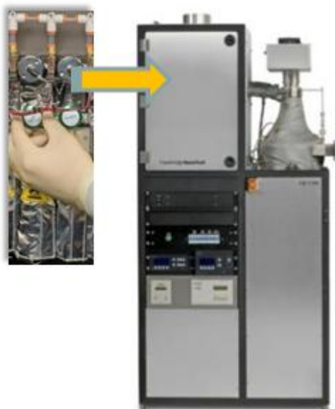
図2-2-8 導入された複合膜ユニット
