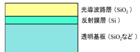
図 2 センサチップの基本構造
