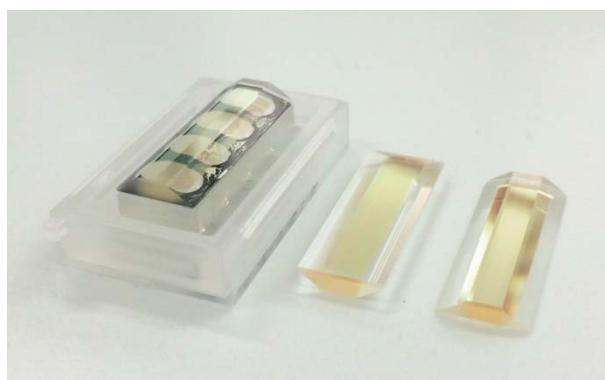
図 20 センサチップ完成品 (左) と多層膜コートプリズム (右)
