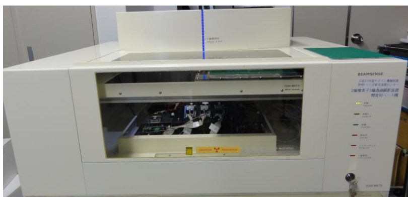
図 4 4 撮像素子型 X 線透過撮影装置の外観図（メンテナンス時）
