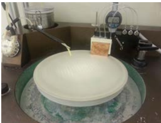
図 2-1-1-3-4 ダミーウェハ貼り付けによる研磨の様子
