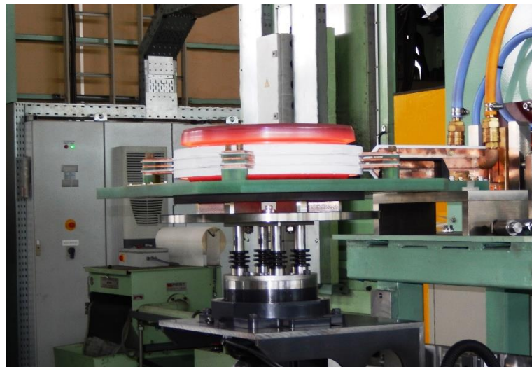
図 2-14 高周波加熱装置
