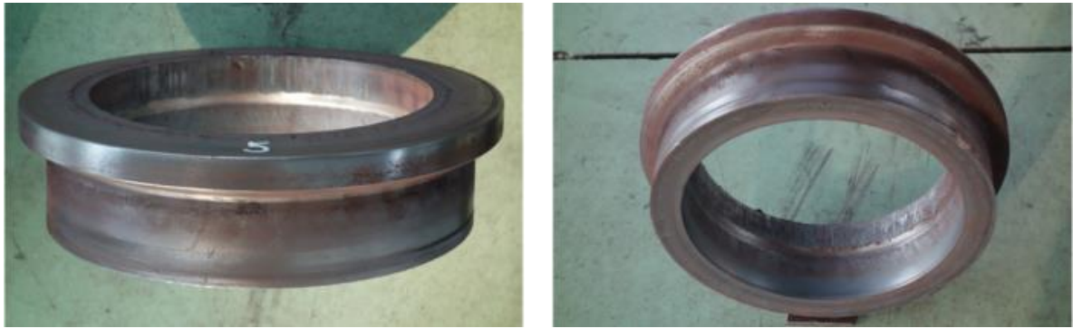
図 2-13 リング鍛造による中間素材
