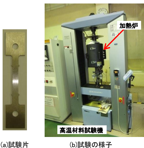
図 2-1 SUS304 高温引張試験
