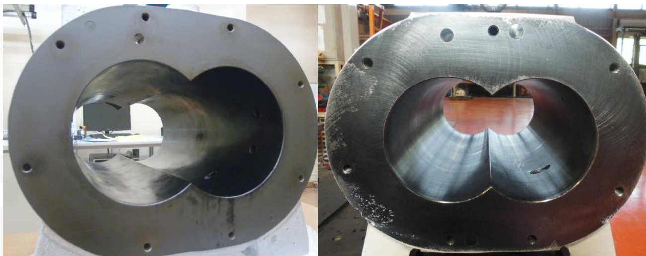
図 2-2-4 運転試験前後のケーシング
