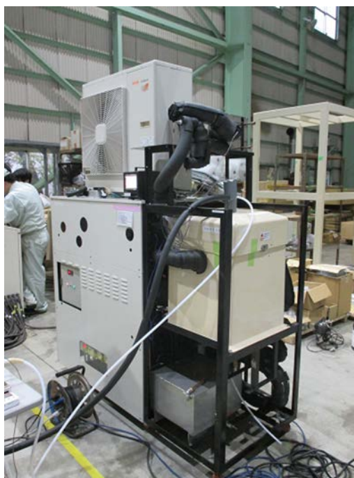
図 2-4-1 排気ガス中揮発有機塩素化合物(VOCC)のハイブリッド型冷却管を用いた冷却凝縮装置
