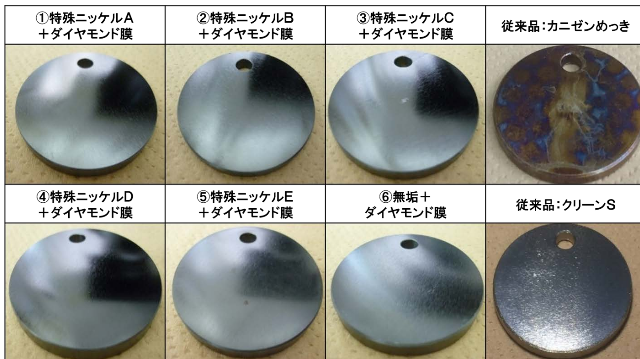
図 2-1-4 ガス腐食試験前のテストピース状態(下地処理・ダイヤモンド膜コーティング後)
