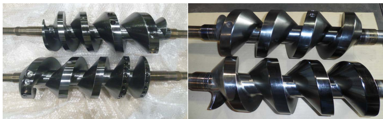
図 2-2-3 運転試験前後のスクローローター
