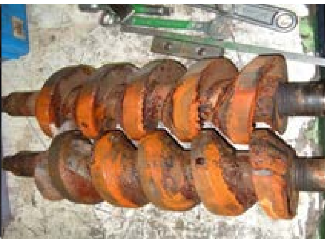
図 2-2-2 従来品真空ポンプの部品の腐食状況
