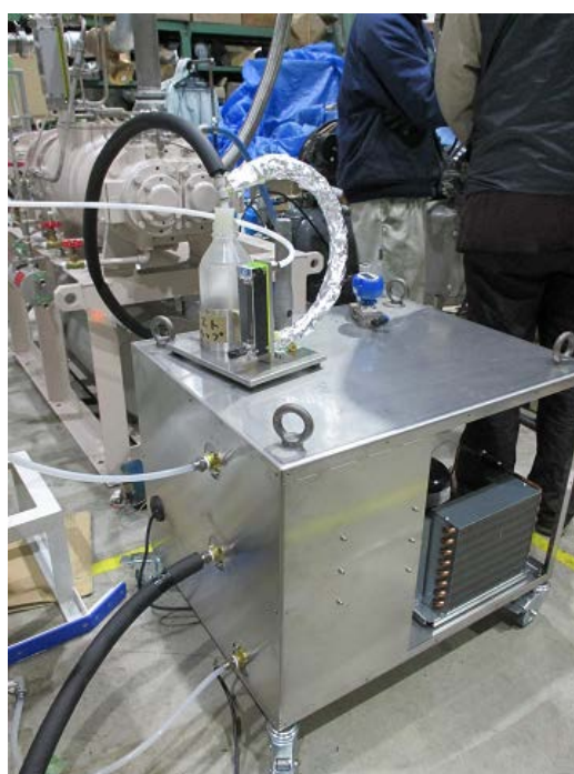
図 2-4-2 排気ガス中水蒸気の冷却凝縮装置
