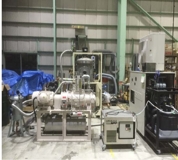
図 2-3-2 溶剤リサイクル装置ユニットの写真
