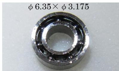
図 4-1-4 Ni 基金属ガラスレースを用いたミニチュアベアリング
