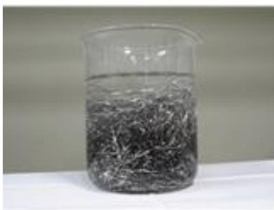
図 1-2-1 Ni 基金属ガラスリボンの 1mass%希硫酸中への浸漬試験結果
