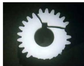
図1 プラスチック歯車の破壊例
