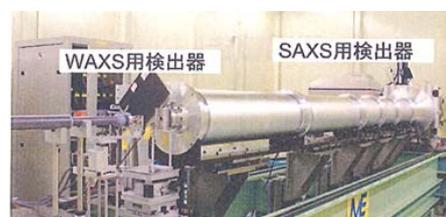
図10 放射光 X 線散乱実験装置
