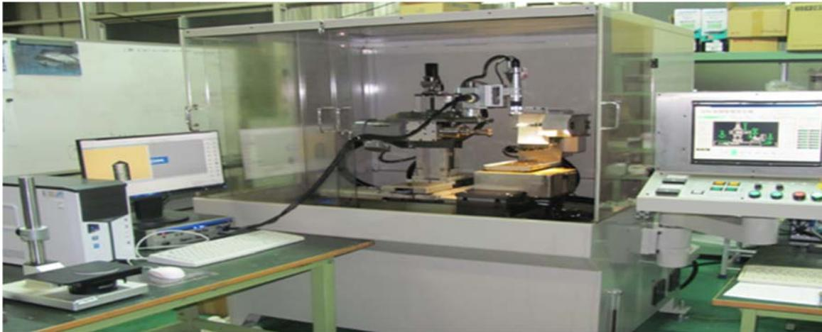
図 回転電極放電加工機
