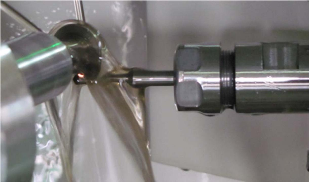
図 溝加工の様子
