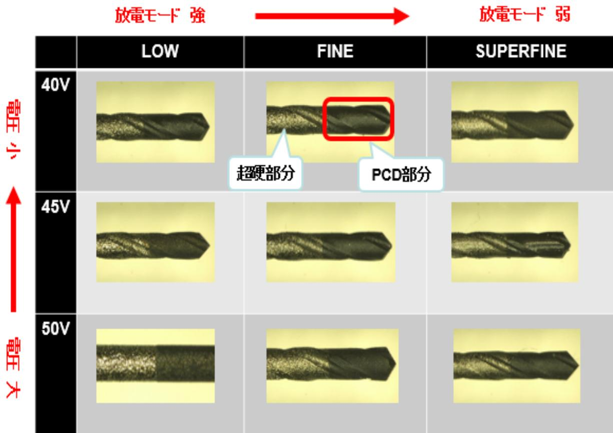
図 放電電圧と放電モードとの面粗度の比較
