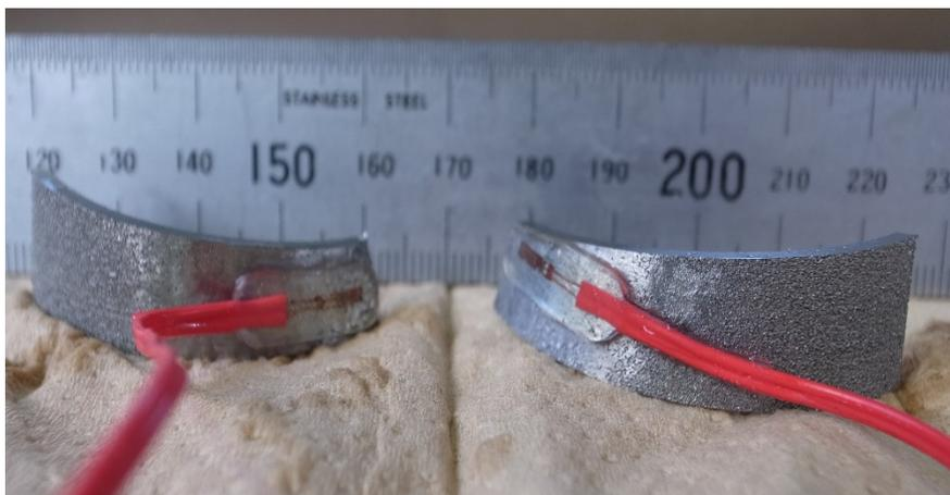
図 6-6 周方向の残留応力測定用供試材の切断後
