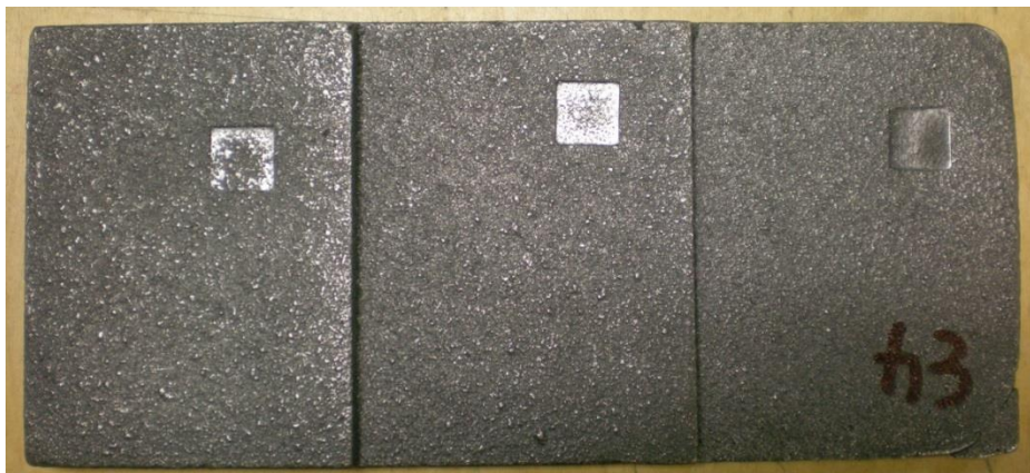
図1 板材の潰し加工
