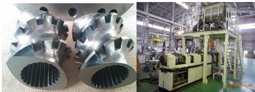
図-2 長繊維用切り欠きパドルと混練機
