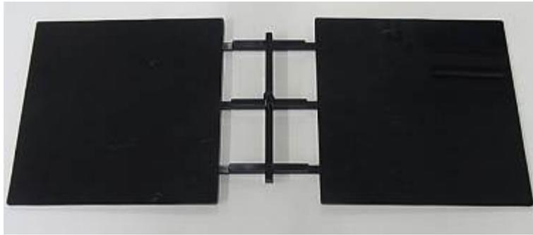
図19. 繊維含有ポリマー複合材の表面外観改良検討のために用いた金型から得られる製品
