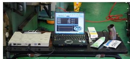
金型のひずみ計測システム
