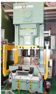
穴加工金型を取り付けたサーボプレスと (左) 高圧ポンプ (右)
