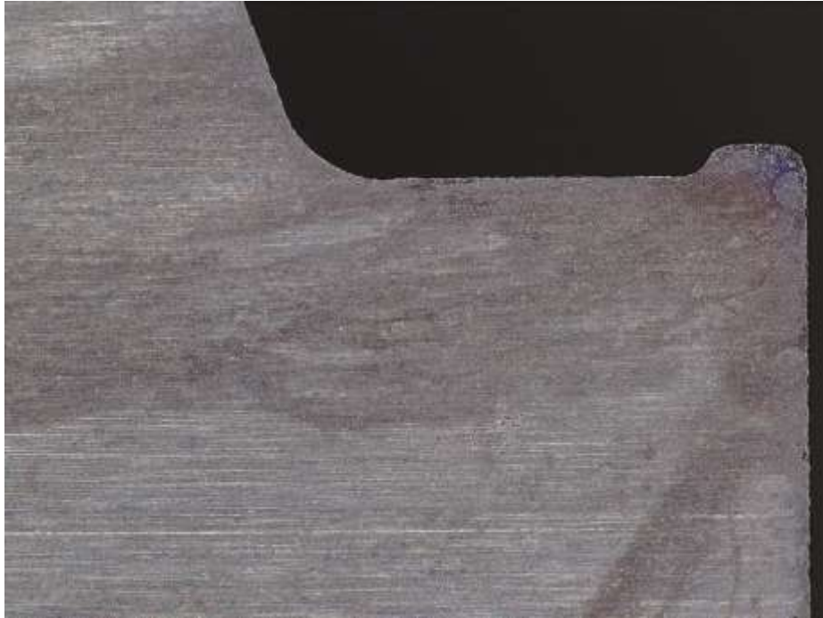
図 34-2(a). サイドカットパンチ B 加工前(マッチング付近)
