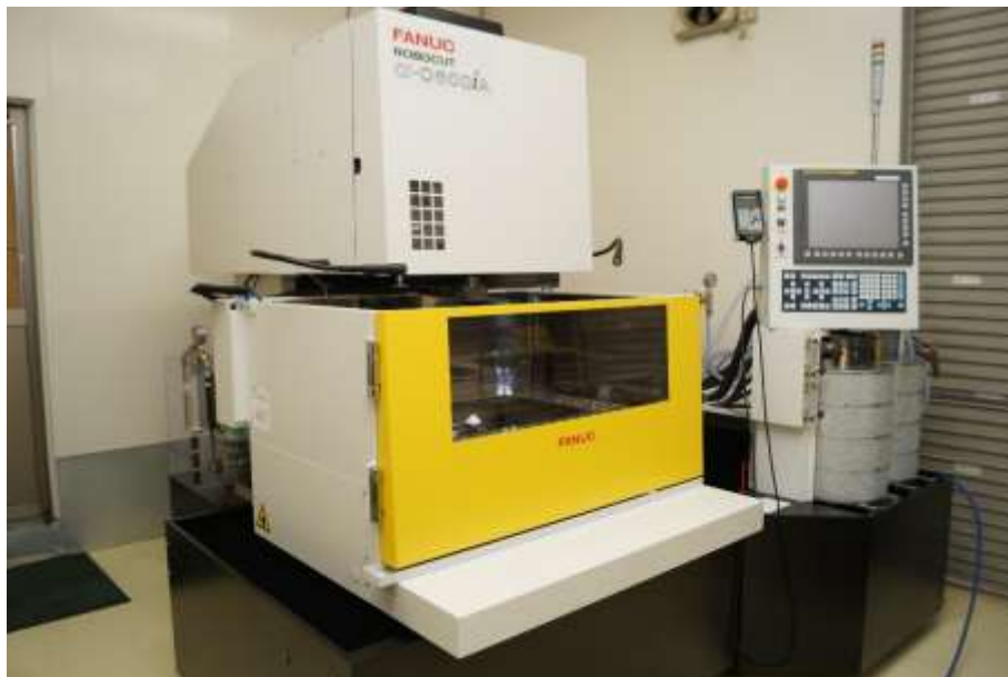
図 14. 特殊電源ワイヤー放電加工機
