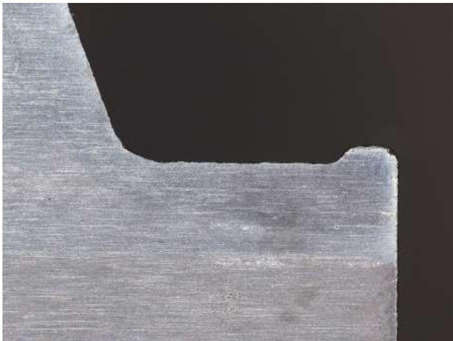
図 34-2(b). サイドカットパンチ B 加工後(マッチング付近)
