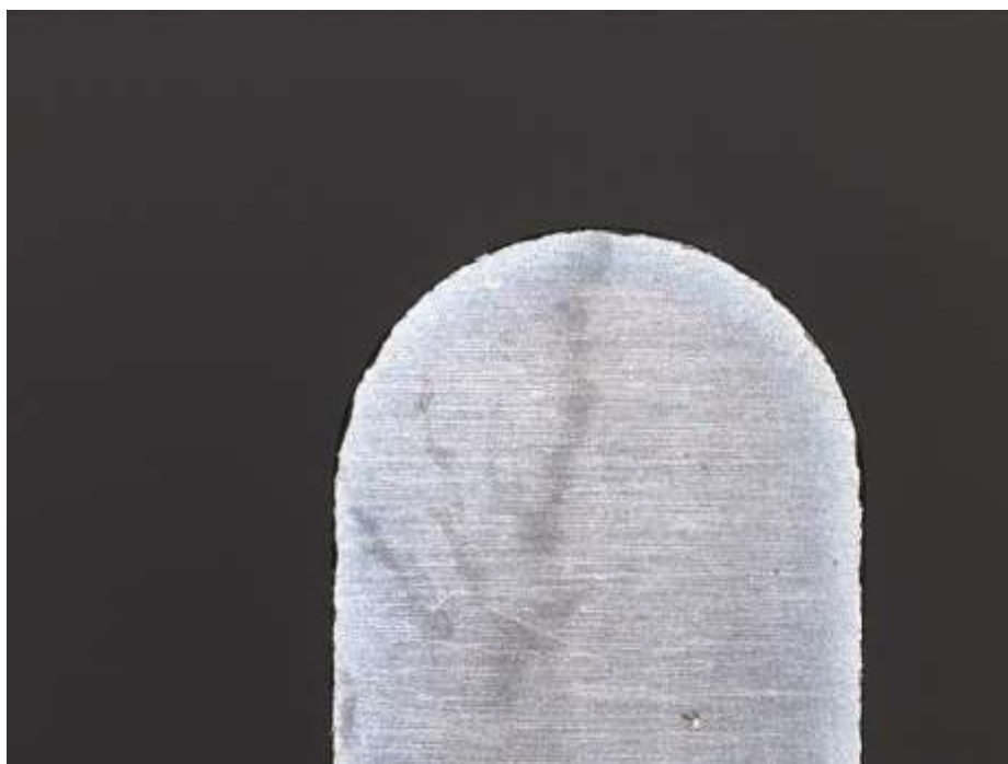
図 34-1(b). サイドカットパンチ B 加工後(先端)
