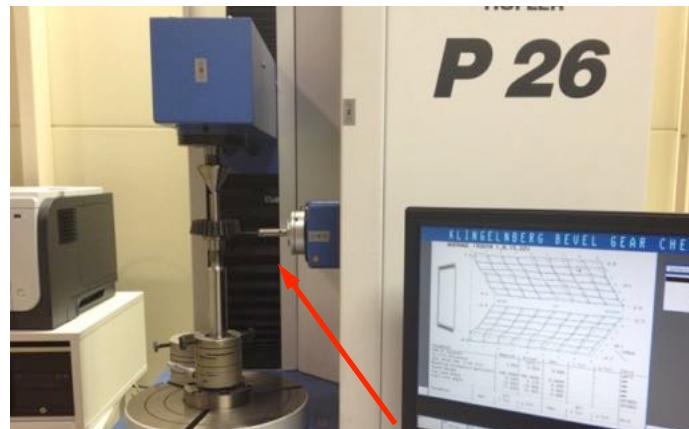
図2 歯車試験機による測定
