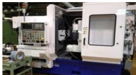
図25 5軸ダイレクトモーター同期制御円筒歯車研削盤
