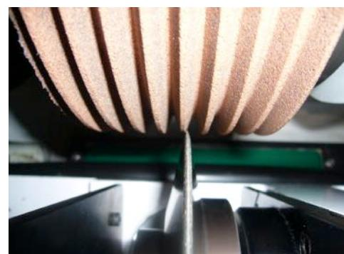
図27 ドレッシング制御プログラム実行時の様子
