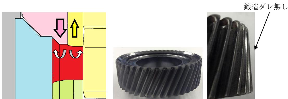
図7 ヘリカルギヤの分流成形鍛造品 (荷重220t)
