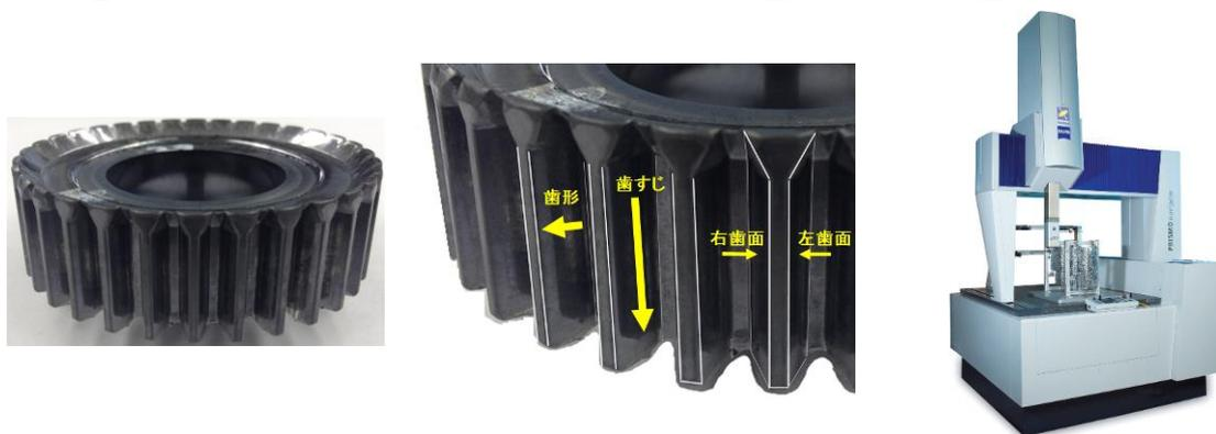
図8 スパークギヤ鍛造品で示した右歯面・左歯面の定義
