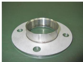
溶着部分の熱の影響によるフランジ面の歪は、電極構造で抑制することができる。しかし、管が薄い場合は、溶着部の熱による歪対策が必要である。
