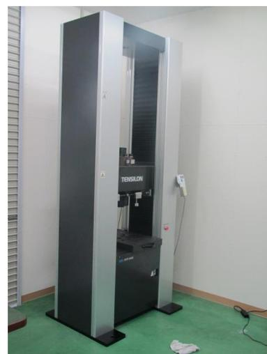
高速応答高精度可変式専用引張およびせん断負荷試験装置
