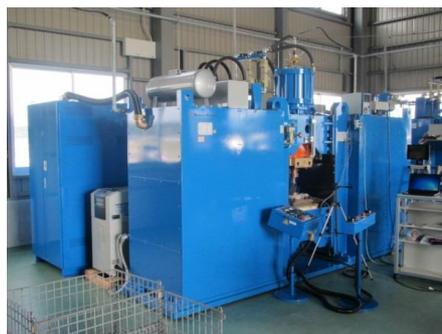
フュージョン溶着機(本体)及び大容量コンデンサー装置
