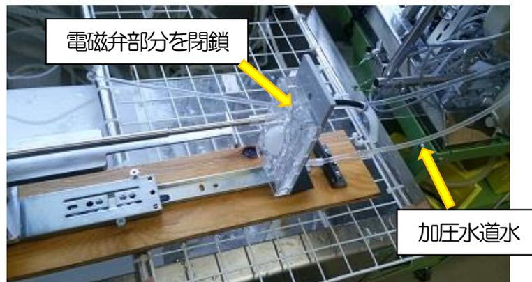
写真7 カセット型透析液回路耐圧試験
