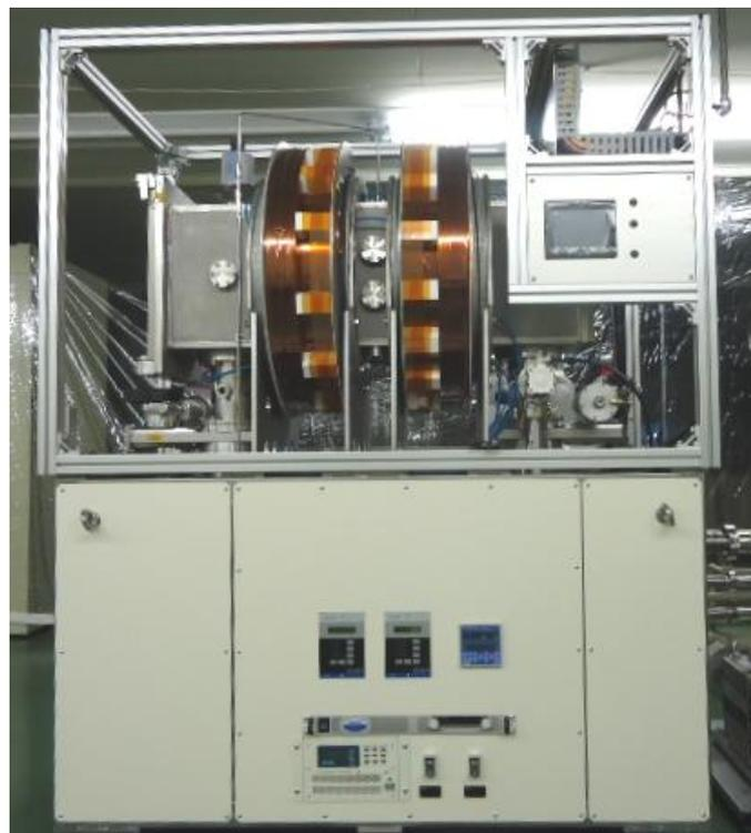
図2-5 小型水晶板用プラズマエッチング装置
