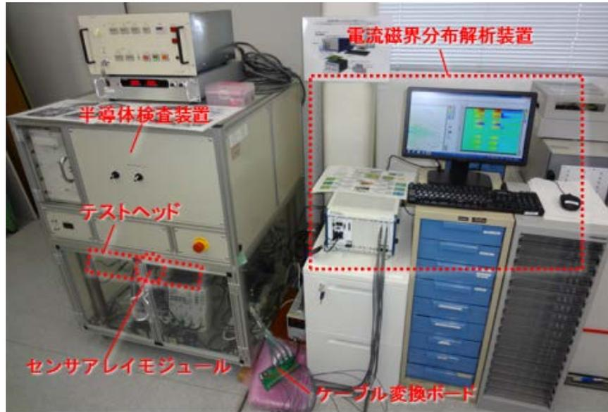
写真-3-1: IGBT 試験用検査装置(電流磁界分布解析システム組み込み)
