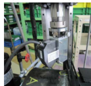
円筒伸び・傾き計測
