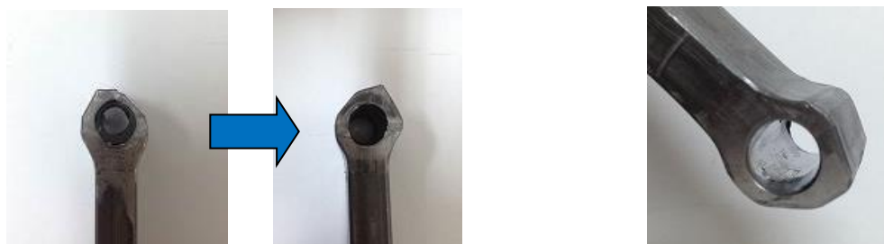
図2-3-1-2 孔あけ位置修正前・修正後、抜き返し仕上げ加工
