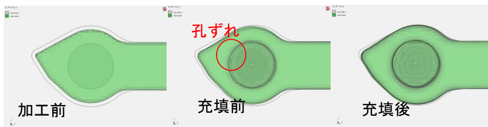
図2-4-1-1 パンチの弾性歪みのシミュレーション
