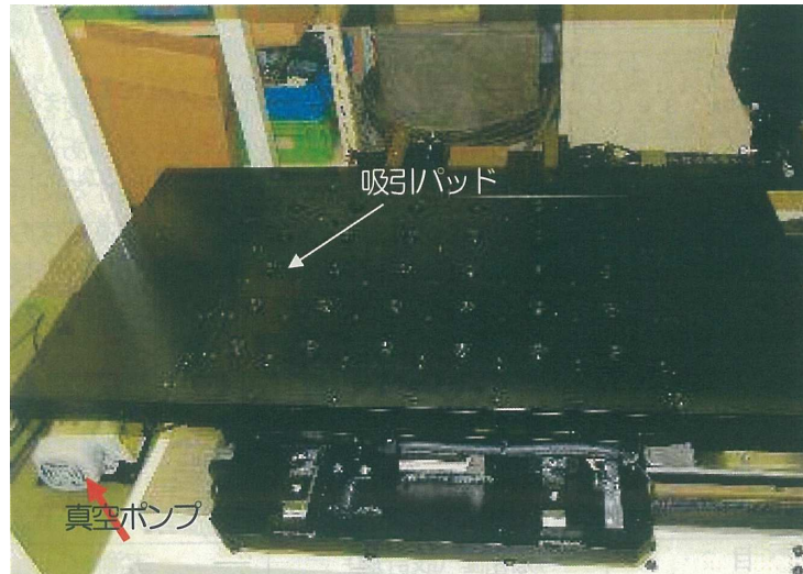
ワーク取り付け台 (XYリニアステージ)
