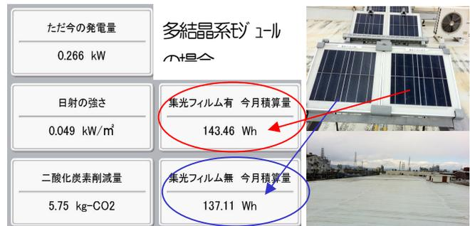
図3. 結晶系モジュールでの発電検証（1）
