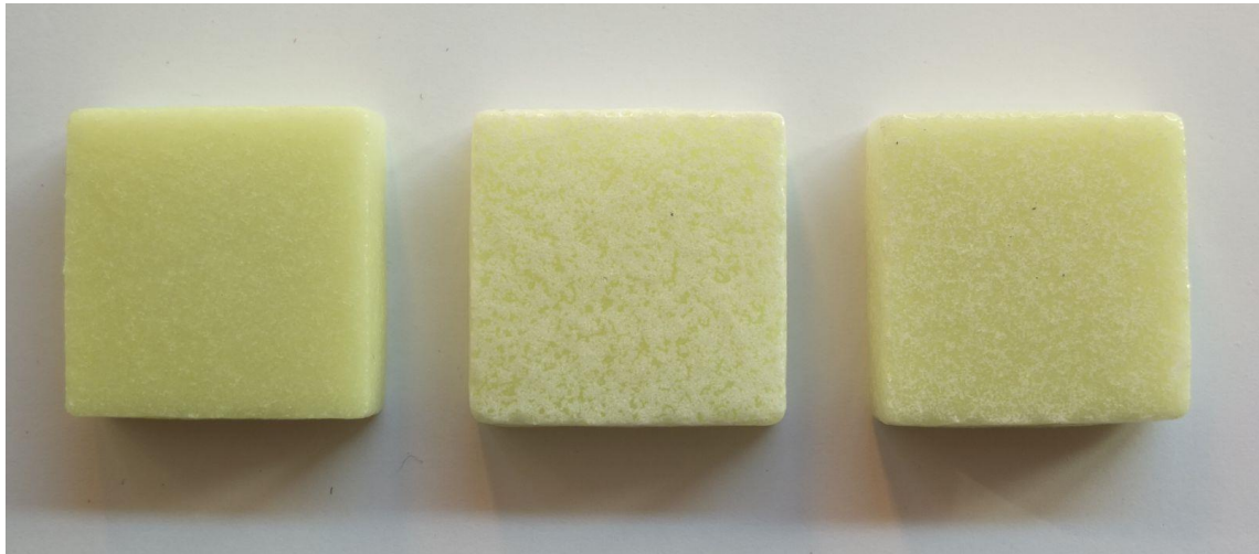
図 2-4-2 プレス成型焼成体の耐酸性テスト結果。左：耐酸試験前、中：現行フリット使用、右：耐酸フリット使用
