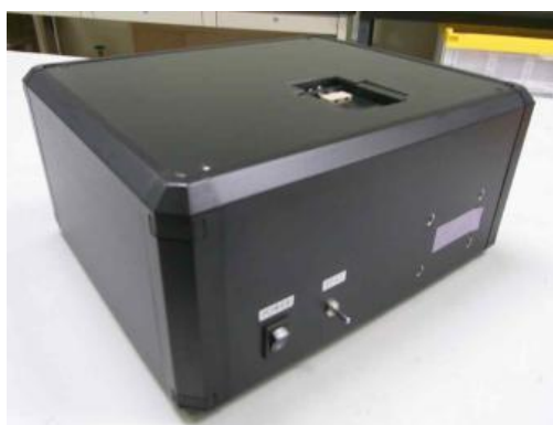
図 17 導波モードセンサの基本構成。
