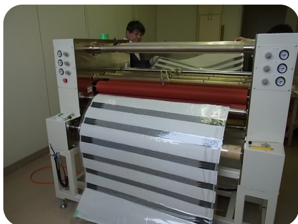
図 4-1 熱ラミネート機 とそれを使用した加工試験
