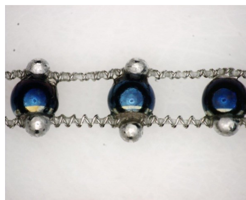
図 2-2 エネルギー創出糸拡大写真 ※球状太陽電池は上が正極、下が負極
