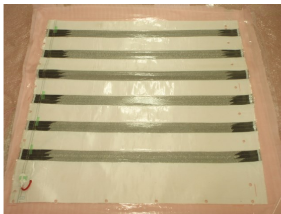
図 4-2 熱ラミネート機で加工したエネルギー創出機能膜材
